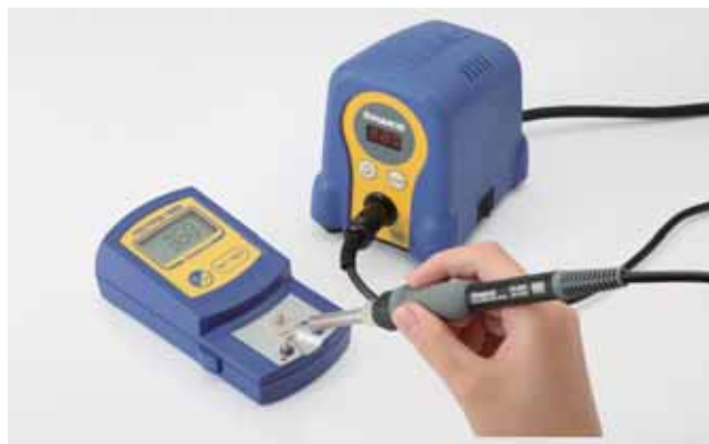
Mesure de la température de la panne avec un thermomètre pour pannes (HAKKO FG-100)
